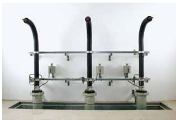
DURESCA 123 кВ 2500 А (Испытательная лаборатория, Хорватия)
