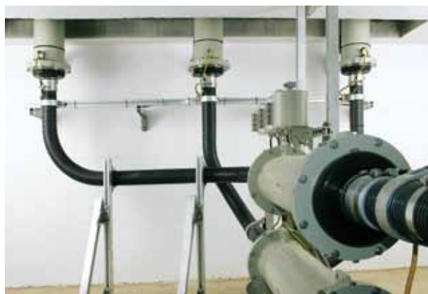
DURESCA 123 кВ 2500 А (Испытательная лаборатория, Хорватия)
