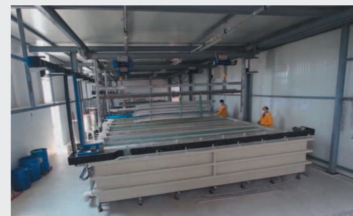
Процесс покрытия проводников оловом
